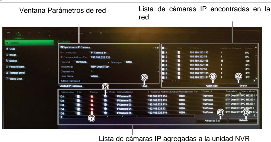
Figura 35: Ventana Cámara IP
