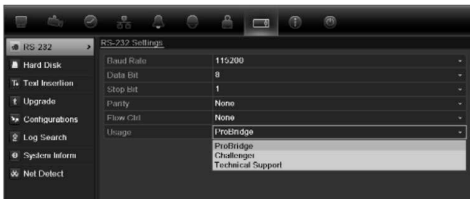
Figure 29 : Fenêtre de configuration du RS-232
